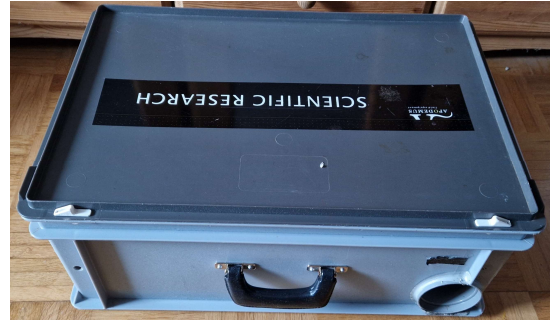
Abb. 6: Fotobox von Apodemus Field Equipment. Rechts ist der Einschlupf für Kleinsäuger zu sehen; der Ausgang befindet sich genau gegenüber auf der Rückseite des Koffers. (Foto: A. Happe)
