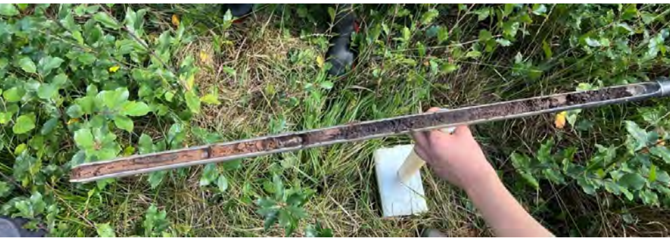
Abbildung 76: Bodenkundliche Untersuchungen mit der 1 m-Peilstange (Pürckhauer). Über 50 cm Torfmächtigkeit über Gley. Im Aufschluss werden die Bodenhorizonte gemessen, die Bodenart, die Bodenfarbe und der pH-Wert des Bodens bestimmt. Zudem wird der aktuelle Grundwasserstand erfasst (2024).
