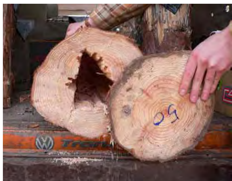
Abbildung 30: Blick von unten in einen Fledermauskasten. Ein Stamm von 30 cm Dicke und 40 cm Länge wurde ausgehöhlt.
