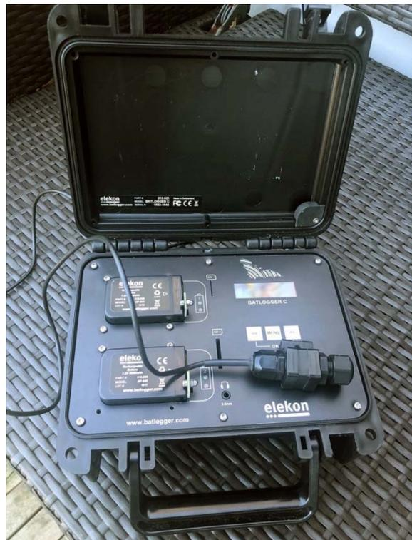
Abb. 2 und 3: Fledermausdetektoren Batlogger M (links) und Batlogger C, der Fa. Elekon, Luzern (Fotos: S. Schlag).
